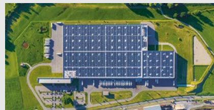
Abb. 5: Das perfekt integrierte Solardach des Logistikzentrums in Perlen/LU mit der 6,4 MW PV-Anlage produziert mit jährlich 7,33 GWh – mehr als doppelt so viel wie es benötigt. Und mehr als 4 Kleinwasserkraftwerke (KWKW) . Mit dem Solarstromüberschuss können 3000 E-Autos jährlich 12 000 km CO 2 -frei fahren, mit dem gesamten Solarstrom sogar 5200 E-Autos. Dies entspricht der PW-Flotte einer Kleinstadt.
